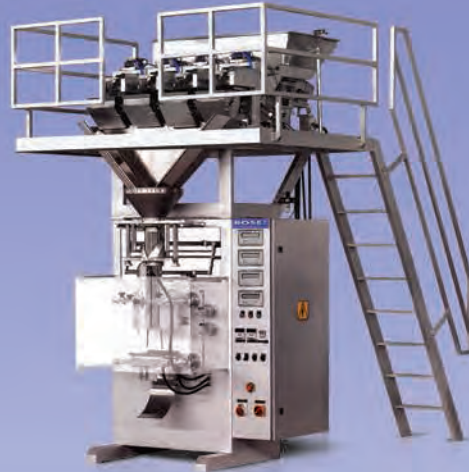
دستگاه بسته بندی عمودی چهار توزین جهت بسته بندی کلوچه لقمه ای، قند، چای، شکر، حبوبات خشکبار، چیپس، تافی، آبنبات، بیسکویت و ...
