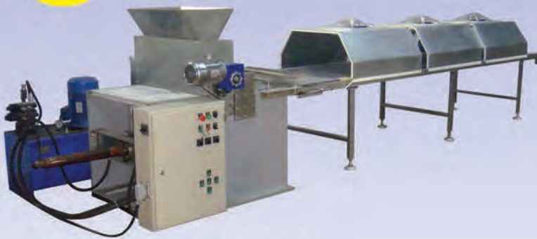
خط تولید قند پرسی مجهز به سیستم PLC
