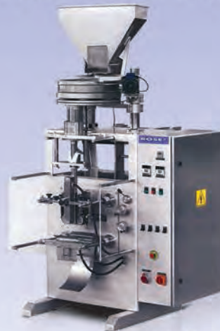
دستگاه بسته بندی حجمی جهت بسته بندی مواد گرانولی از قبیل تخمه، پسته برنج، حبوبات، پفک، پودر شوینده، شکر و ...
