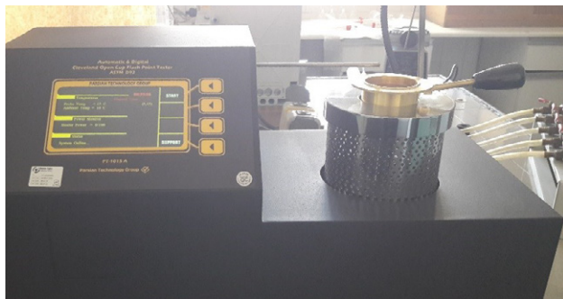
شکل ۲. دستگاه اندازه‌گیری نقطه اشتعال روغن‌های معدنی
