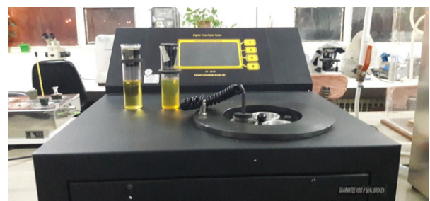
شکل ۴. دستگاه اندازه‌گیری نقطه ریزش روغن‌های معدنی
