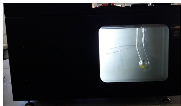
شکل ۳. دستگاه اندازه‌گیری ویسکوزیته روغن‌های معدنی
