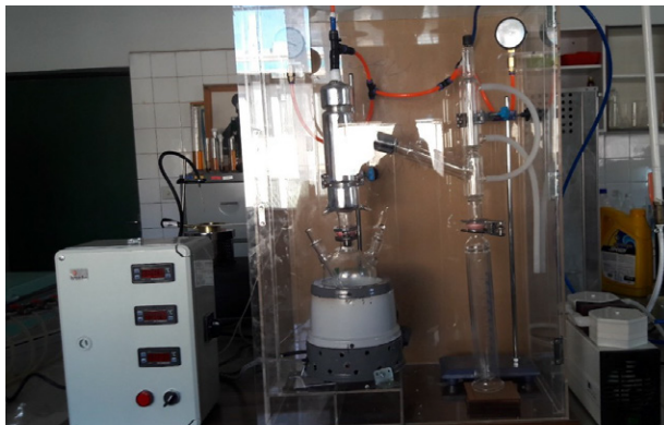
شکل ۵. برج تقطیر در خلاء جهت تعیین نقطه جوش و دامنه جوش روغن‌های معدنی
