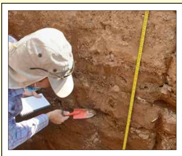
شکل ۸- نمونه برداری از اعماق مختلف همراه با ثبت موقعیت جغرافیایی هر نقطه
