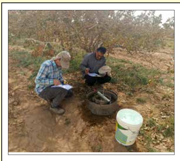
شکل ۹- اندازه‌گیری نفوذ آب در خاک به روش حلقه‌های مضاعف (Double ring infiltrometer)
