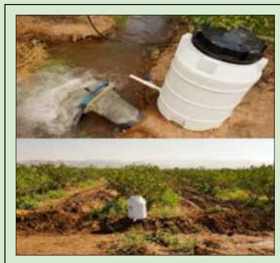
نمونه‌ای از تانکر پلی اتیلنی ویژه کاربرد اسید سولفوریک در آبیاری غرقابی سنتی در باغ‌های پسته
