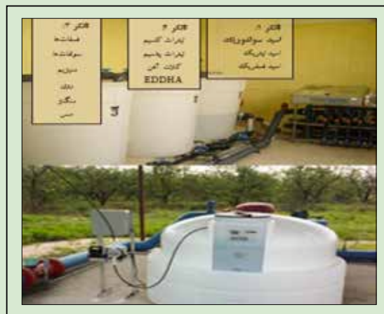
تانکر ویژه تزریق اسید سولفوریک در سیستم‌های آبیاری تحت فشار به همراه پمپ تزریق مخصوص اسید
