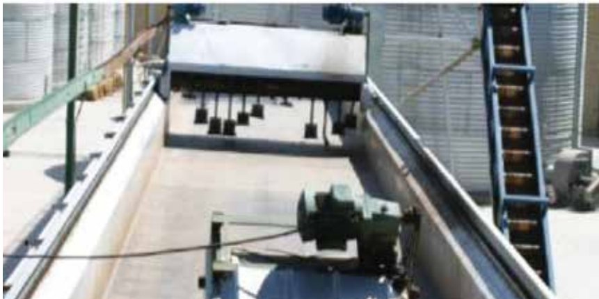
شکل ۴- خشک کن پیوسته دارای نوار نقاله
