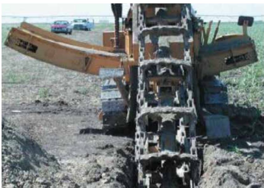
شکل ۴. تجهیزات مورد استفاده برای نصب یک سیستم آبیاری قطره ایی زیرسطحی
