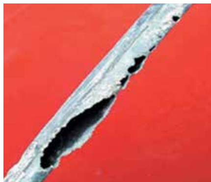
شکل ۶. صدمه وارد شده به خط لوله توسط جوندگان
